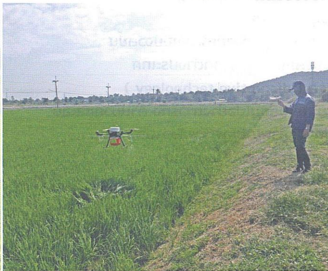
รูปแบบการพ่นสารอารักขาพืชในนาข้าวด้วยโดรนหรืออากาศยานไร้คนขับ
