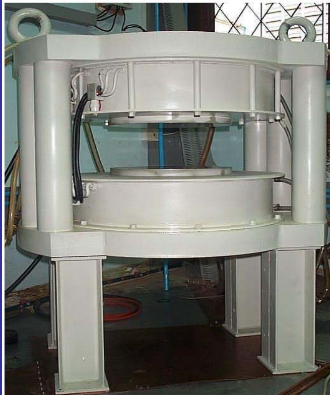
Gap 15.4cm, pole dia. 40 cm 0.3T ที่กระแส ~60 A
