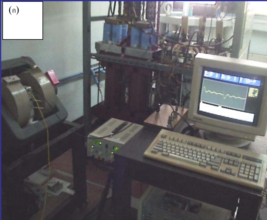
แสดงการจัดอุปกรณ์และ (ข) สัญญาณ NMR ในการทดสอบ pre-amplifier กับเครื่อง RI NMR spectrometer ที่ความถี่ประมาณ 12.9MHz
