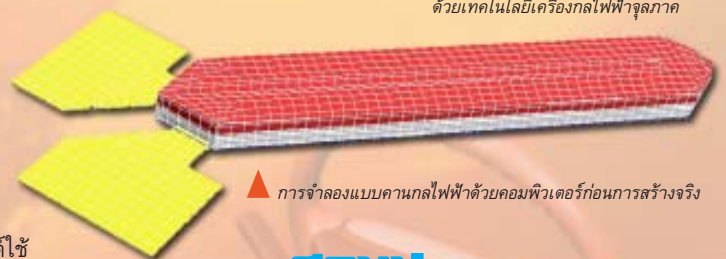
การศึกษาพฤติกรรมของคานกลไฟฟ้าด้วยคอมพิวเตอร์ก่อนการสร้างจริง
