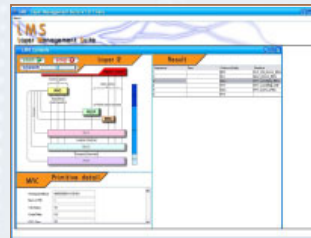
รูปที่ 3 ตัวอย่างโปรแกรม LMS (Layer Management Suite) เพื่อใช้ในการเชื่อมต่อสัญญาณและโปรแกรมย่อยต่างๆ ตลอดจนการตรวจวัดการตั้งค่าต่างๆ ของแต่ละหน่วยและรายละเอียดของ Primitive โปรแกรมย่อย
