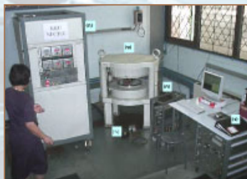
รูปที่ 2 เครื่อง KUKU-NECTEC MRI ที่กำลังพัฒนา (ก) ตัวจ่ายไฟแก่ขดลวดแม่เหล็กและตัวจ่ายไฟแก่ขดลวด Shims 6 ชุด (ข) แม่เหล็กพร้อมขดลวดวิทยุ ขดลวดเกรเดียนท์และสารตัวอย่างอยู่ภายใน วางอยู่ระหว่างขั้ว มี Shims ติดอยู่บนหน้าขั้ว (ค) เครื่องขยายกำลังความถี่วิทยุ (ง) โต๊ะทำงานเมื่อภาพแสดงโปรแกรม KUKU-NECTEC MRI Scanner และมิ่งจอร์จระจอยอยู่ใน 4 ลิ้นชัก จากบนเป็นคอมพิวเตอร์ร่วมกับโปรแกรมควบคุมการทำงาน ระบบจ่ายกำลังแก่ขดลวดเกรเดียนท์ ระบบส่งคลื่นวิทยุ และระบบรับสัญญาณวิทยุ (จ) เครื่องขยายสัญญาณเบื้องต้นวางอยู่ข้างแม่เหล็ก
