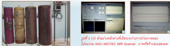
รูปที่ 4 ขดลวดวิทยุ ขดลวดเกรเดียนท์ทั้งหมดหลังพันด้วยลวด ทำด้วยวานิช และโครงทองเหลือง สำหรับใช้ประกอบเข้าชุด
