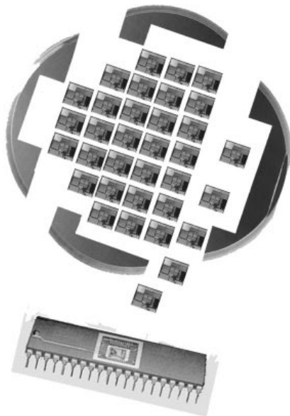
▲ แผงวงจรรวมที่นำตัดประกอบเป็นตัวไอซี (IC Packing)
