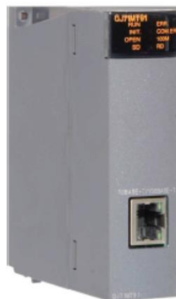
รูปที่ 17 Mitsubishi Q-series PLC โมดูล QJ71MT91 [Ref. 4]
