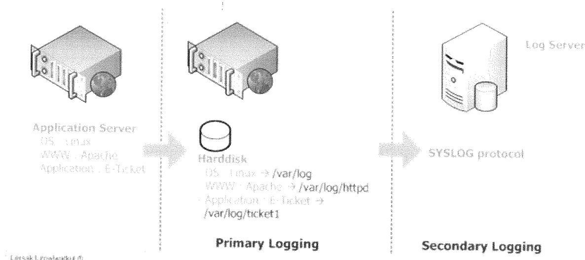
รูปที่ ค.๒ การจัดเก็บข้อมูลจราจรทางคอมพิวเตอร์แบบปฐมภูมิ (primary logging)
