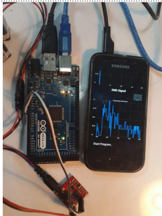
รูปที่ 7.24 แสดงการเชื่อมต่อเซ็นเซอร์ EMG กับบอร์ด Arduino
