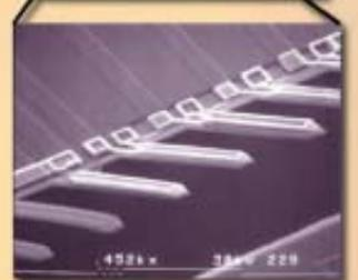
ภาพที่ถ่ายด้วย Scanning Electron Microscope แสดงคานกลไฟฟ้าที่สร้างด้วยเทคโนโลยีเครื่องกลไฟฟ้าจุลภาค
