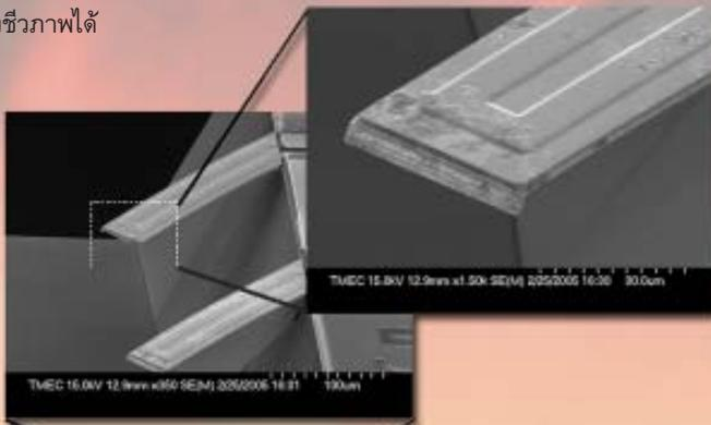
ภาพที่ถ่ายด้วย Scanning Electron Microscope แสดงคานกลไฟฟ้าที่สร้างด้วยเทคโนโลยีเครื่องกลไฟฟ้าจุลภาค
