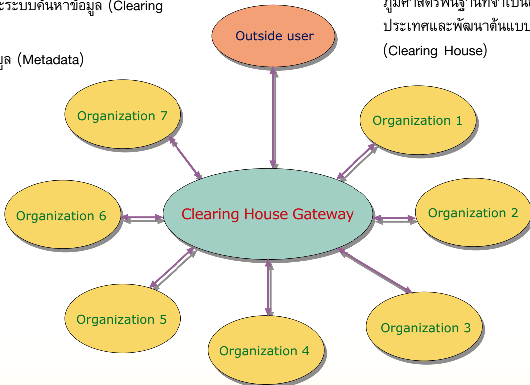
ภาพที่ 1 แสดงให้เห็นถึงโครงสร้างการทำงานของ Clearing House Gateway โดยองค์กรต่างๆ และผู้ใช้จากภายนอกสามารถเรียกสืบค้น Metadata data ได้โดยผ่าน Clearing House Gateway
