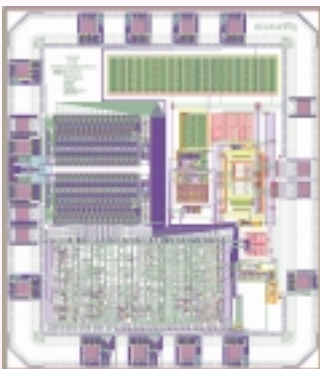
วงจร RFID Tag (พ.ศ. 2545) งานวิจัยออกแบบวงจรรวม เนคเทค เทคโนโลยี 0.8 (ม) พื้นที่ 4 (m2) บริการทำต้นแบบ Europractice
