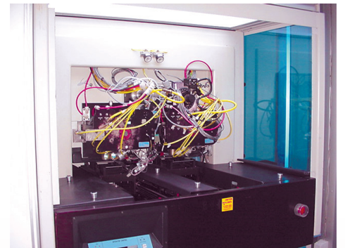
เครื่องยิงฝังประจุ Varian รุ่น 350D ติดตั้งใช้งานที่ ศูนย์วิจัยอิเล็กทรอนิกส์ สถาบันเทคโนโลยีพระจอมเกล้าเจ้าคุณทหารลาดกระบัง ภายใต้การดูแลของศูนย์เทคโนโลยีไมโครอิเล็กทรอนิกส์ (TMEC)
