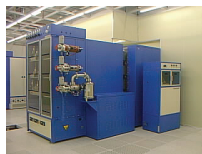
เครื่อง LPCVD SVG THERMOCO รุ่น TMX 2604 ติดตั้งที่ศูนย์เทคโนโลยีไมโครอิเล็กทรอนิกส์ (TMEC) จ.ฉะเชิงเทรา สำหรับการปลูกฟิล์มบางบนแผ่นซิลิคอนเส้นผ่านศูนย์กลางสูงสุด 6 นิ้ว
