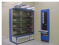
เครื่อง LPCVD SVG THERMOCO รุ่น TMX 2604 ติดตั้งที่ศูนย์เทคโนโลยีไมโครอิเล็กทรอนิกส์ (TMEC) จ.ฉะเชิงเทรา สำหรับการปลูกฟิล์มบางบนแผ่นซิลิคอนเส้นผ่านศูนย์กลางสูงสุด 6 นิ้ว
