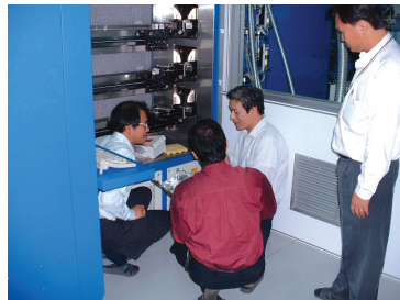
เครื่อง LPCVD SVG THERMOCO รุ่น TMX 2403 ติดตั้งที่ศูนย์วิจัยอิเล็กทรอนิกส์ สถาบันเทคโนโลยีพระจอมเกล้าเจ้าคุณทหารลาดกระบัง ในการดูแลของศูนย์เทคโนโลยีไมโครอิเล็กทรอนิกส์ (TMEC) สำหรับการปลูกฟิล์มบางบนแผ่นซิลิคอนเส้นผ่านศูนย์กลางสูงสุด 4 นิ้ว
