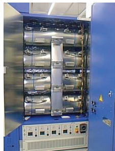
เครื่อง LPCVD SVG THERMOCO รุ่น TMX 2604 ติดตั้งที่ศูนย์เทคโนโลยีไมโครอิเล็กทรอนิกส์ (TMEC) จ.ฉะเชิงเทรา สำหรับการปลูกฟิล์มบางบนแผ่นซิลิคอนเส้นผ่านศูนย์กลางสูงสุด 6 นิ้ว
