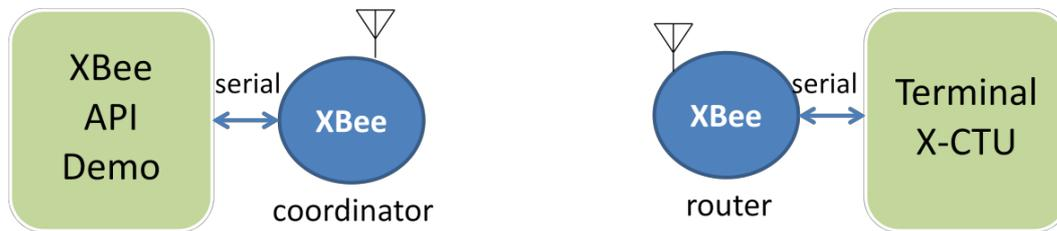
ภาพประกอบที่ L2.3 การเชื่อมต่อโนตเพื่อทดสอบการส่งข้อมูลแบบ API แบบที่ 1
