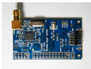
ภาพประกอบที่ 2.7 โหนดที่ใช้ในการรับค่าจากเซนเซอร์และใช้ควบคุม
