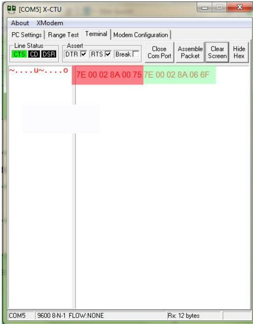
ภาพประกอบที่ L2.6 Hardware reset ของข้อความ API แบบ Modem Status
