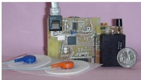
(ค) เซนเซอร์ไร้สายที่มี ECG amplifier
