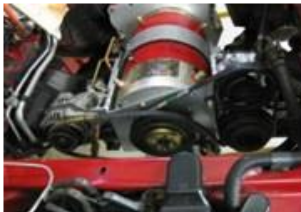
รูปที่ 8 การใช้มอเตอร์ traction เป็นต้นกำลังขับเคลื่อนสายพานระบบ auxiliary
