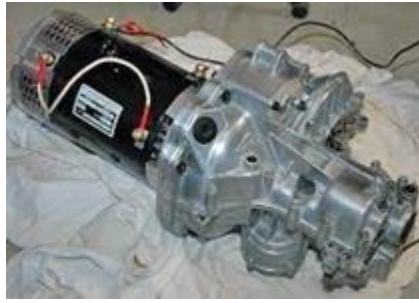
รูปที่ 4 การประกบมอเตอร์กับชุดเกียร์ด้วย adapter plate ในรถยนต์ขับเคลื่อนล้อหน้า
