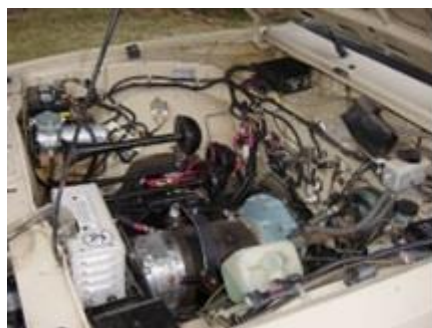
รูปที่ 3 การดัดแปลงรถยนต์ขับเคลื่อนล้อหลังโดยนำมอเตอร์มาประกบกับชุดเกียร์ด้วย adapter plate
