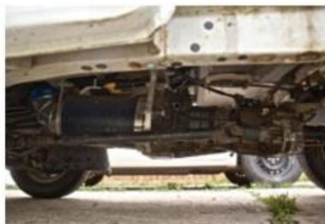
รูปที่ 3 การดัดแปลงรถยนต์ขับเคลื่อนล้อหลังโดยนำมอเตอร์มาประกบกับชุดเกียร์ด้วย adapter plate
