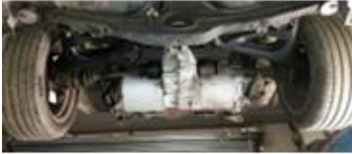
รูปที่ 5 ซ้าย) การติดตั้งชุดมอเตอร์ Tesla พร้อมเกียร์ differential สำเร็จในตัว ขวา) ชุดมอเตอร์ใหม่พร้อมเกียร์ differential สำเร็จในตัวจากบริษัท Swindon
