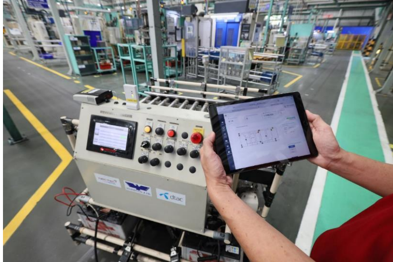
ภาพที่ 4.21 รถ AGV ของโรงงาน DAISIN ในพื้นที่ทดลองติดตามตำแหน่งด้วย Tablet ผ่านเครือข่าย 5G
