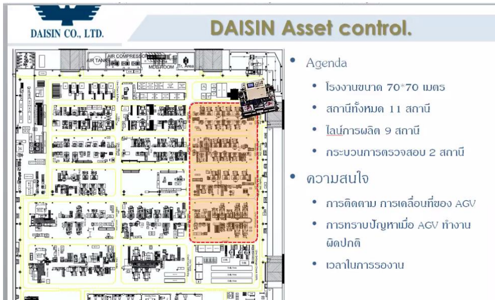
ภาพที่ 4.18 แสดงพื้นที่ใช้งานรถ AGV ของโรงงาน Daisin และความต้องการใช้งาน
