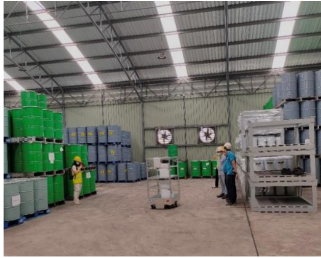
ภาพที่ 4.5 แสดงการทดลองควบคุมรถ AGV ขนาดเล็กเพื่อขนถังบรรจุเลซีทินขนาด 20 กิโลกรัม จำนวน 2 ถัง
