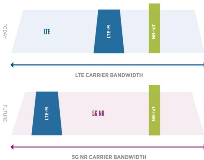
ภาพที่ 3.9 แสดงการวิวัฒนาการ NB-IoT ให้เป็นส่วนหนึ่งของเทคโนโลยี 5G ในการให้บริการ LPWA
