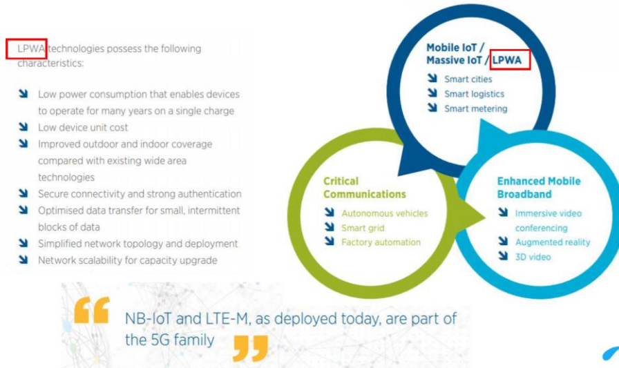
ภาพที่ 3.8 แสดงข้อมูล NB-IoT และ LTE-M ที่จะมีวิวัฒนาการไปเป็นส่วนหนึ่งของมาตรฐาน 5G
